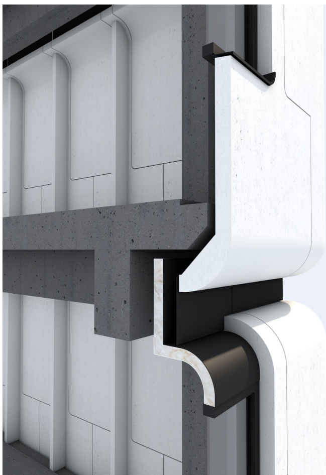
Изобр. 24 Детайл-разрез от фасадата, BIM модел
